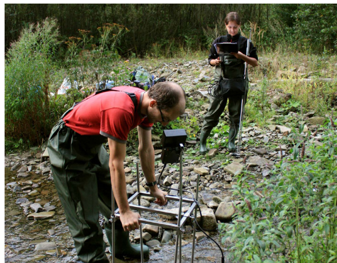
Měření říčních charakteristik a průtoků po revitalizačním zásahu
