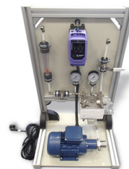
Laboratorní crossflow model membránové filtrace (MF, UF, NF, RO)
